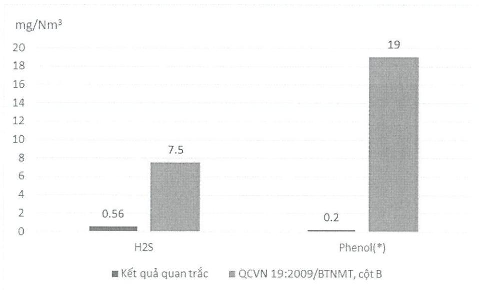
**Hình 2. Biểu đồ kết quả phân tích các thông số có trong khí thải lò nung so sánh với tiêu chuẩn QCVN 19:2009/BTNMT, cột B.**
