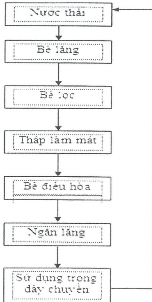
**Hình 1. Sơ đồ công nghệ xử lý nước thải của nhà máy thép Việt Ý**
