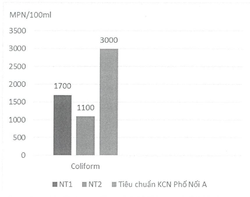
**Hình 3. Biểu đồ kết quả phân tích các thông số có trong nước thải sinh hoạt trước và sau xử lý so sánh với tiêu chuẩn đầu nổi của khu CN Phố Nối A.**
